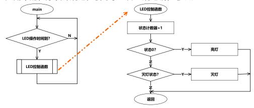
图 3 基于状态机的 LED 任务函数
