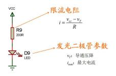
图 1 发光二极管核心参数
