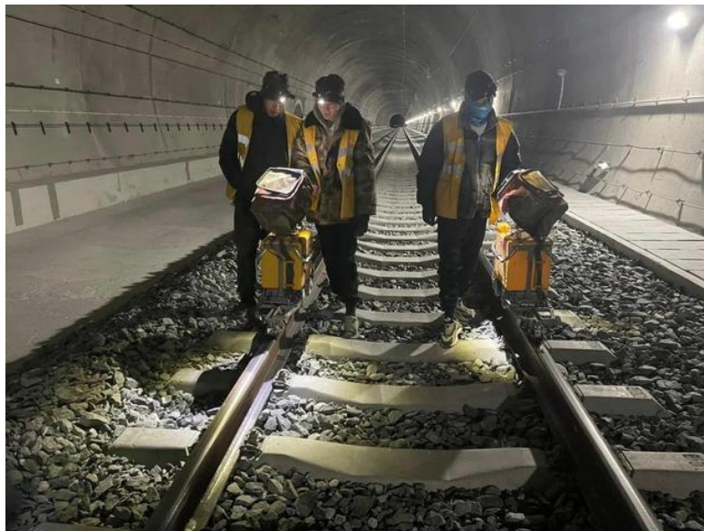
图 2 超声波探伤仪检测铁轨
