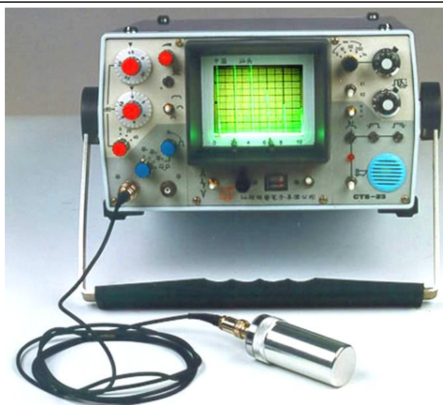
图 3 超声波探伤仪示意图，了解超声波无损探伤原理
